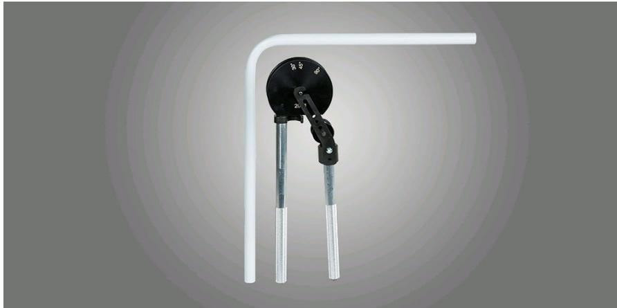
Besonders anwender- und montagefreundlich: Mit unserem neuen alpex Rohrbieger-Set 2xDa biegen Installateure Rohre für die Trinkwasser- und Heizungsinstallation mit wenigen Handgriffen in den gewünschten Rohrwinkel. Die Handbiegegeräte für die Rohr-Dimensionen 16 mm und 20 mm sparen Formteile, erhöhen so die Sicherheit und verringern Druckverluste.
