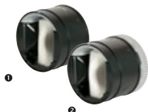
Regulador de caudal constante (RCC) autorregulado para regulación de caudal sin energía auxiliar, automática, sin necesidad de mantenimiento y que puede colocarse en cualquier lugar, con elemento regulador exento de desgaste en la carcasa de plástico en combinación con el colector plano profi-air classic de 6 conexiones, así como con el colector profi-air classic plus. Para montar directamente en el manguito recto de conexión profi-air classic. Valor de tolerancia: +/- 5 m³/h.
