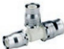
TE salidas diferentes compuesta de PPSU para instalaciones de sistemas de A.C.S. y calefacción con casquillos de acero inoxidable fijos e indicadores ópticos para verificar el correcto posicionamiento. La conexión puede ser liberada durante la instalación en las dimensiones de 16 y 20 mm mediante herramientas especiales.
