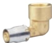
Adaptador de codo con salida rosca hembra conforme a DIN EN 10226-1, compuesto de latón resistente al descincado para instalaciones de sistemas de A.C.S. y calefacción, con casquillo de acero inoxidable fijo e indicador óptico para verificar el correcto posicionamiento. La conexión puede ser liberada durante la instalación en las dimensiones de 16 y 20 mm mediante herramientas especiales.
